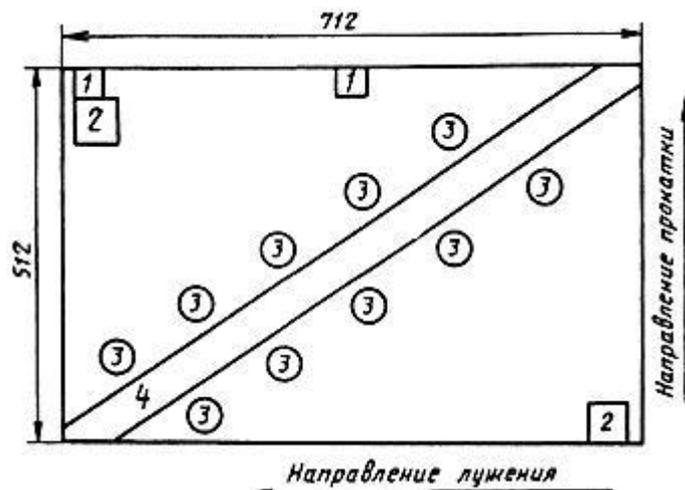
1 - образцы для измерения твердости (70x70 мм); 2 - образцы для измерения оловянного покрытия (100x100 мм); 3 - образцы для определения массы оловянного покрытия ( $\varnothing$  20 мм); 4 - полоса шириной 90 мм по диагонали листа для испытания на выдавливание лунки по Эриксену
