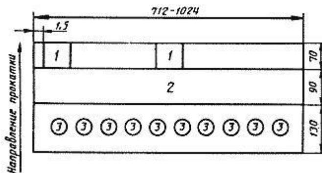
1 - образцы для измерения твердости (70x70 мм); 2- полоса шириной 90 мм для испытания на выдавливание лунки по Эриксену; 3 - образцы для определения массы оловянного покрытия ( $\varnothing$  20 мм)
