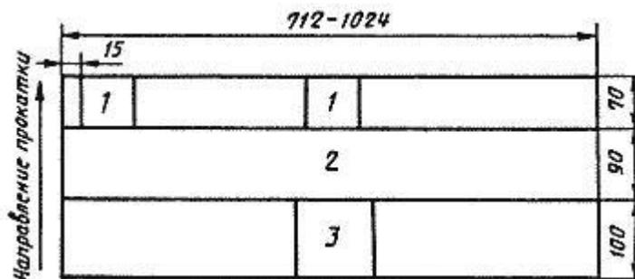
1 - образцы для измерения твердости (70x70 мм); 2 - полоса шириной 90 мм для испытания на выдавливание лунки по Эриксену; 3 - образец для определения параметра шероховатости (100x100 мм)
